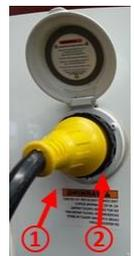
**ACHTUNG:** Bitte die Hausbatterien nicht überbeanspruchen, da sie sich bei zu großem Spannungsverlust nicht wieder aufladen! Ein sehr niedrigen Ladestand kann allein durch Fahren nicht mehr ausgeglichen werden. Die Batterien müssen dann mindestens 8 Stunden über das Außenstromkabel (110 Volt) auf dem Campingplatz aufgeladen werden. Wir sind für anfallende Kosten und/oder Zeitverlust aufgrund überbeanspruchter Hausbatterien nicht verantwortlich.
