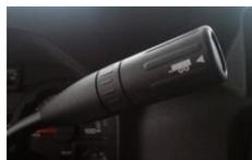
Die Tow/Haul-Funktion optimiert die Schallleistung und verringert die Gefahr einer Überhitzung oder eines Ausfalls des Getriebes durch übermäßiges Schalten beim Fahren in bergigen Gegenden. Sie bietet zusätzliche Leistung beim Bergauffahren und Bremsunterstützung durch den Motor beim Bergabfahren, um das Risiko einer Bremsüberhitzung zu verringern. Diese Funktion wird durch Drücken der Taste im Schalthebel aktiviert.
