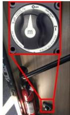
Der Hauptbatterieschalter befindet sich direkt neben der Eingangstür in Bodennähe. Er muß sich in der "ON"-Position befinden, um 12-Volt-Strom für den Wohnbereich abgeben zu können. Sollte keines der 12-Volt-Geräte des Wohnmobils Strom führen, ist es möglich, dass dieser Schalter versehentlich ausgeschaltet wurde.
