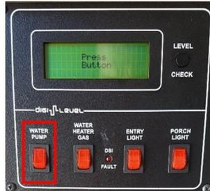
Um Wasser aus dem Wassertank für die Frischwasserversorgung zu entnehmen, muss die Wasserpumpe eingeschaltet sein. Der Schalter befindet sich auf dem Bedienpanel.
